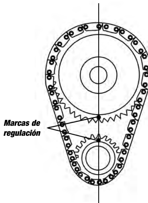
Figura 2 - Alineamiento de la rueda dentada de la cadena de regulación
