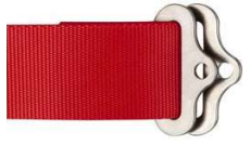
F7 Doppia piastrina di fissaggio in Titanio per nastro 2". Per viti M8. Titanium double fixing plate for 2" webbing. For M8 screw. 38 g
