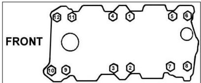
Figure 2—Intake Manifold Torquing Sequence V8—302—307—327—350
