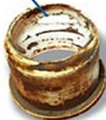
ROULEMENT USÉ ET DÉFAILLANT
