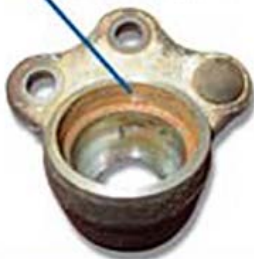
CORROSION DANS LE BOÎTIER INDIQUANT UNE INTRUSION
