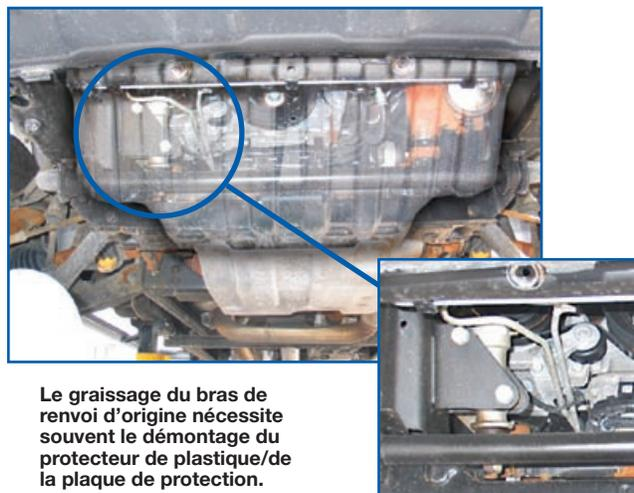
Le graissage du bras de renvoi d'origine nécessite souvent le démontage du protecteur de plastique/de la plaque de protection.
