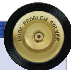
Ces bras de renvoi MOOG comportent un boyau de rallonge de graisseur exclusif qui reloge le graisseur du bras de renvoi sur le support du cadre de la barre stabilisatrice. L'entretien régulier se fait simplement, car le graisseur devient accessible par le passage de roue et l'entretien ne nécessite plus le démontage de la plaque de protection.
