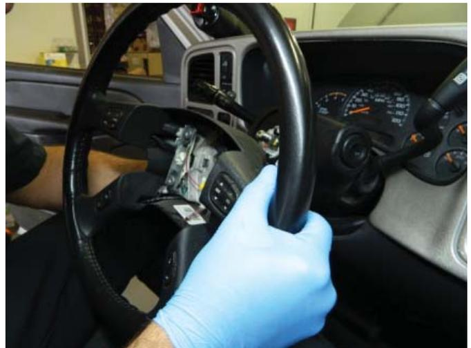
**ÉTAPE 9 :** À l'aide d'un tournevis plat, d'un pic ou d'un autre outil non-abrasif, détachez les couvercles supérieur et inférieur de la colonne de direction.
