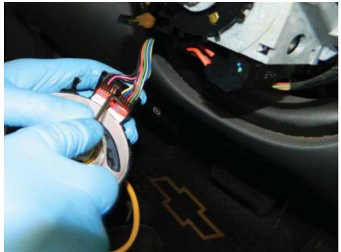
**ÉTAPE 17 :** Pelez soigneusement le ruban connecteur de chacun des faisceaux de câbles.
