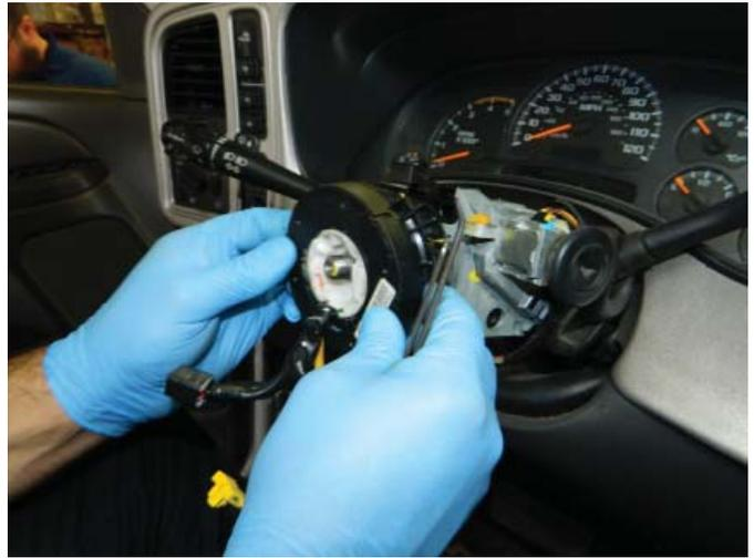
**ÉTAPE 13 :** Positionnez le faisceau de connecteurs de fil et installez le séparateur de fils à ½ po du contacteur annulaire tel qu'illustré. **Avertissement!** Une mauvaise installation des connecteurs peut entraîner le mauvais fonctionnement du système de coussin de sécurité ou le déclenchement accidentel du coussin, ce qui peut causer des blessures ou la mort.
