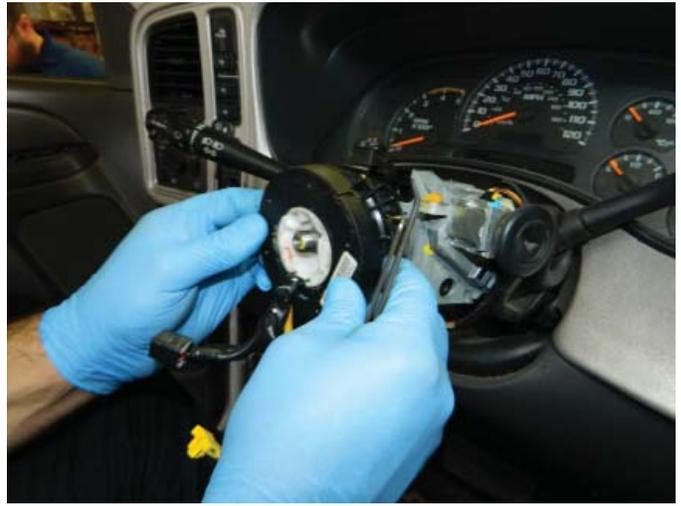
**PASO 13:** Acomode los conectores de los cables e instale el gancho separador de cables a 1/2" del resorte helicoidal, como se muestra. **¡Advertencia!** El no instalar los conectores con la orientación correcta podría causar una falla del sistema de bolsa de aire o provocar la activación accidental del mismo causando heridas o la muerte.
