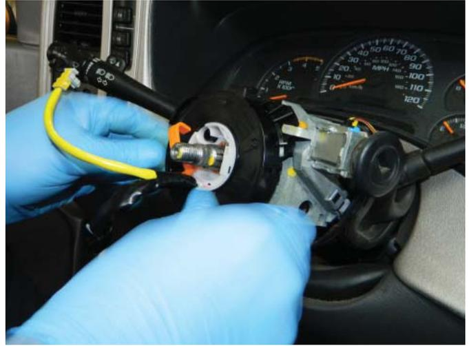
**PASO 6:** Con una pinza, vuelva a instalar el anillo de retención del resorte helicoidal.
