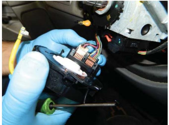
**PASO 3:** Los colores de los cables deben coincidir con la etiqueta del resorte helicoidal.
