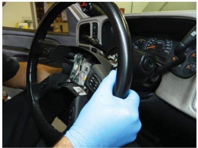
**PASO 9:** Con un destornillador plano, punzón u otra herramienta que no deje marcas, destrabe las cubiertas superior e inferior de la columna de dirección.
