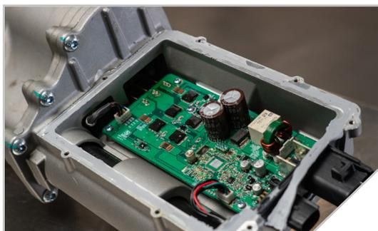
Componentes electrónicos recubiertos para evitar la penetración de agua y la corrosión
