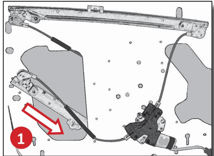
**ÉTAPE 2 :** Insérez le haut du rail droit dans le trou de droite. Le bout du rail glissera vers le haut entre la vitre et la portière pour permettre au bas du rail d'être inséré. Montez les rails à la portière sans trop serrer. Fixez la vitre au lève-vitre et réglez les rails pour le bon alignement.
