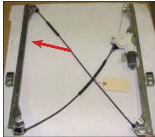
Les Pièces de Rechange OE N'ont Pas Ce 3e Support de Fixation
