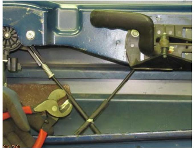
**ÉTAPE 5 :** Desserrez les boulons de la glissière de la vitre juste assez pour être en mesure de facilement séparer la vitre des colliers. N'enlevez pas les boulons ou ne les desserrez pas entièrement. La vitre doit être soutenue par les colliers jusqu'à ce qu'elle soit bien installée de façon sécuritaire.
