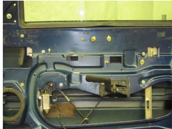
**ÉTAPE 8 :** Serrez les six boulons de 10 mm du lève-vitre dans l'ordre suivant : boulons A, D, C, F, B, E. Serrez à un couple de 9 Nm (80 po. lbs).
