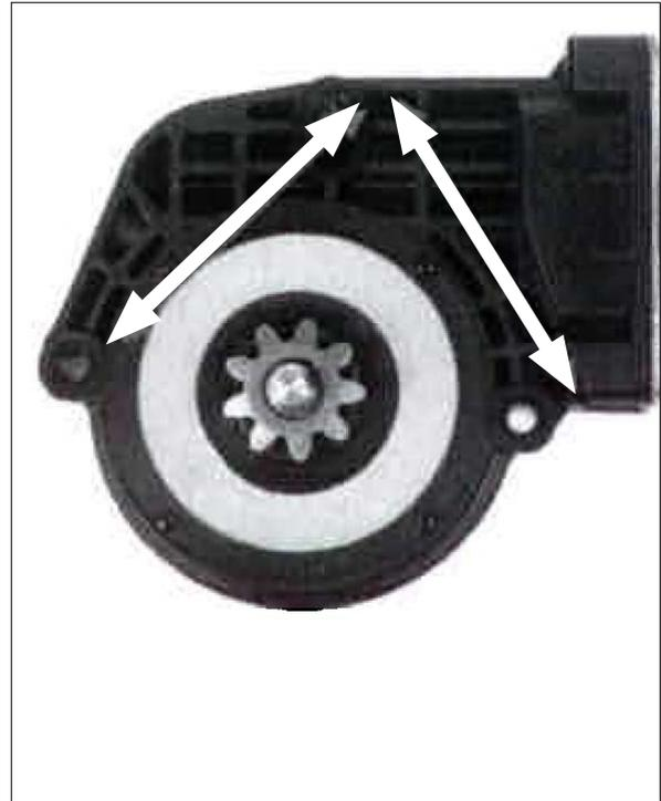
Bien des lève-glace d'équipement d'origine et de rechange sont dotés d'un troisième trou allongé qui s'adapte aux moteurs avec une distance de 62 mm ou de 66 mm entre les trous.
