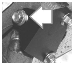
Aplique compuesto de bloqueo de roscas a alta temperatura a las roscas del perno de sujeción y apriete a 23-33 Nm (17-24 ft-lb). Apriete solo hasta que el escape se selle.
