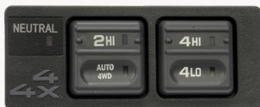
Interrupteur de sélection de quatre roues motrices
