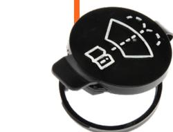
Tapa del depósito de líquido del limpiaparabrisas
